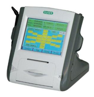
Pachimetro con sonda a 20MHz per la misurazione automatica dello spessore corneale.
